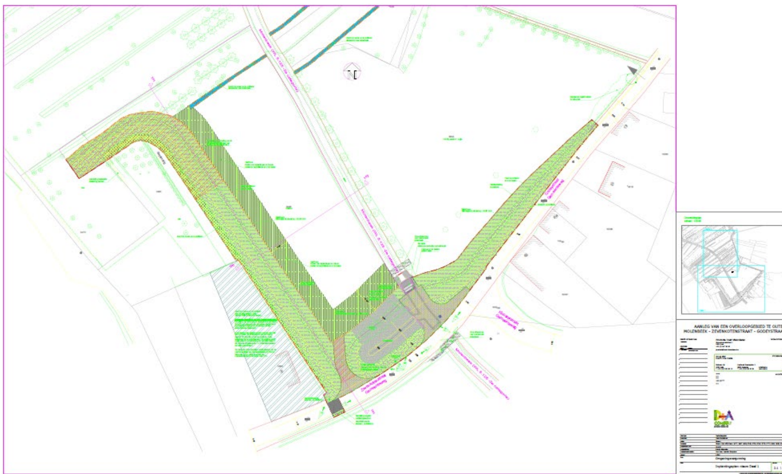
Figuur 5: Ontwerpplan van de bedijking met bufferbekken (bron: D+A NV)
